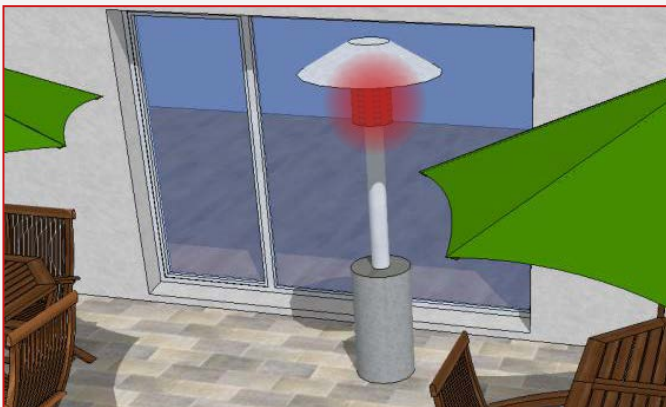
Un parasol chauffant, ou tout autre dispositif de chauffage à proximité de la baie vitrée.
